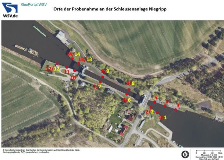
**Abbildung 2:** Lage der Probeentnahmeorte an Spundwänden der Schleusenanlage Niegripp: Binnenhafen BH 1-5, Schleusenkammer 6-9, Außenhafen AH (Elbe) 10-14. Die Probeentnahmestellen für mikrobiologische Untersuchungen an der MPA Bremen sind gelb, die für chemische Untersuchungen an der BAW rot dargestellt.
