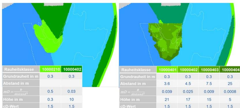
**Abbildung 5:** Rauheitsklassen des 2D-HN-Modells ohne RiverCloud-Daten (links) und mit RiverCloud-Daten (rechts)
